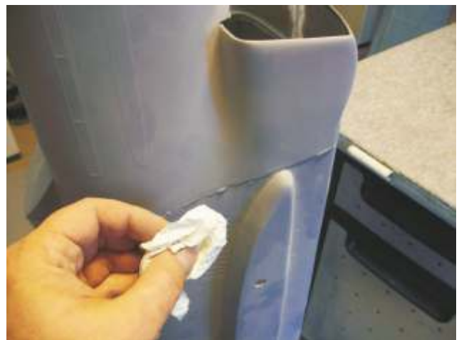
Wipe off excessive epoxy Überschüssiges Epoxy wegwischen
