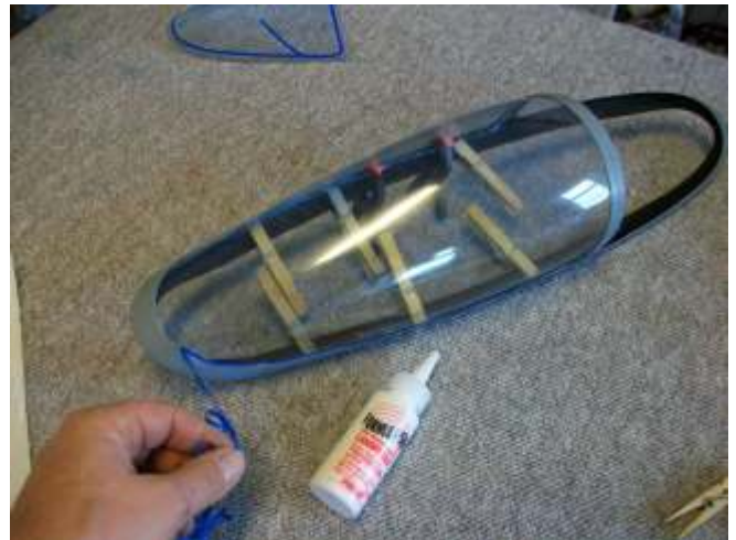
Use clamps and magnets to fix parts Klammern und Magnete zum Fixieren
