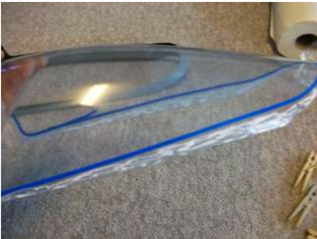
Protect glass above glue joint Abkleben gegen Klebeschmier
