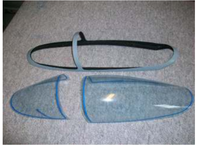
Cut canopy in two pieces Teilen der Verglasung
