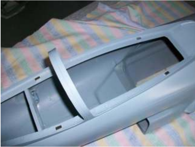
Drill holes for alignment - pins Kleine Stifte zum Zentrieren
