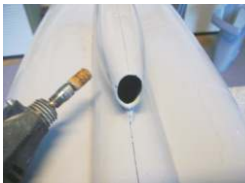
Roughen contact surfaces Aufrauen der Kontaktflächen
